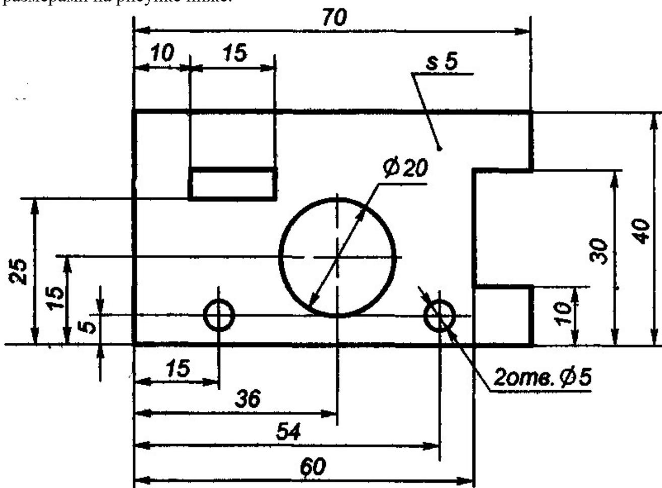
3. Нанесите на получившийся чертеж габариты, толщину и заполните основную надпись.
